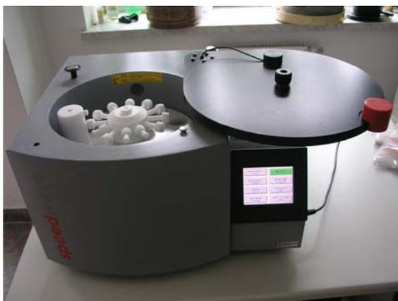
Системы микроволнового разложения **SPEEDWAVE** позволяют сократить время подготовки пробы с нескольких часов, а иногда и суток до 15-45 минут за счет высоких температуры и давления реакционной смеси, получаемых в поле микроволнового излучения. Герметичность автоклавов позволяет избежать испарения вредных веществ в атмосферу лаборатории и минимизировать потери летучих компонентов анализа неизбежные в случае классического кислотного разложения.
